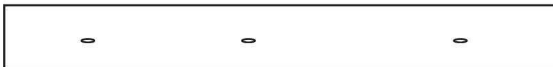
Пример 3 — три несплошности длиной по 3,2 мм
