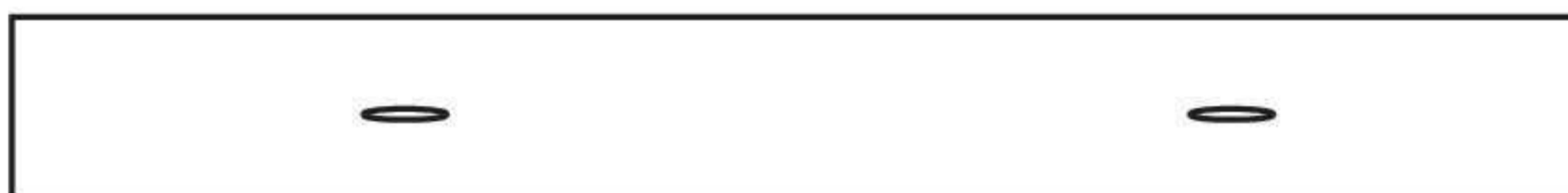
Пример 2 — две несплошности длиной по 6,4 мм
