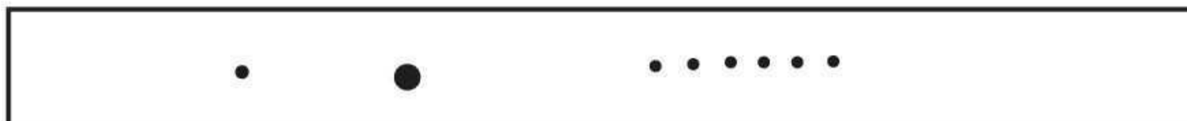
Пример 3 — одна несплошность диаметром 3,2 мм; одна — 0,8 мм; шесть — по 0,4 мм
