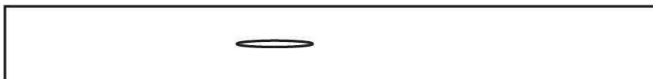
Пример 1 — одна несплошность длиной 12,7 мм
