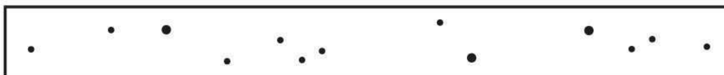
Пример 8 — три разбросанные несплошности диаметром по 0,8 мм; десять — по 0,4 мм
