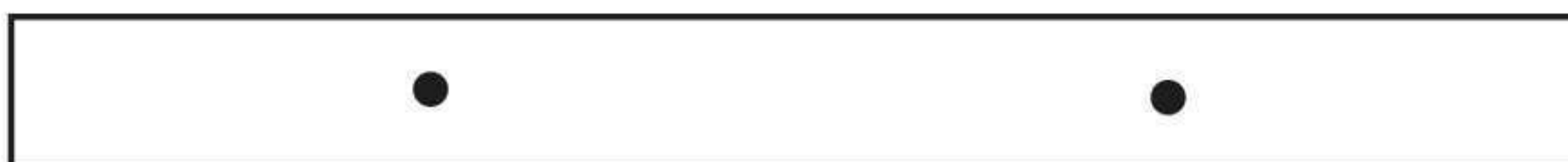
Пример 1 — две несплошности диаметром по 3,2 мм
