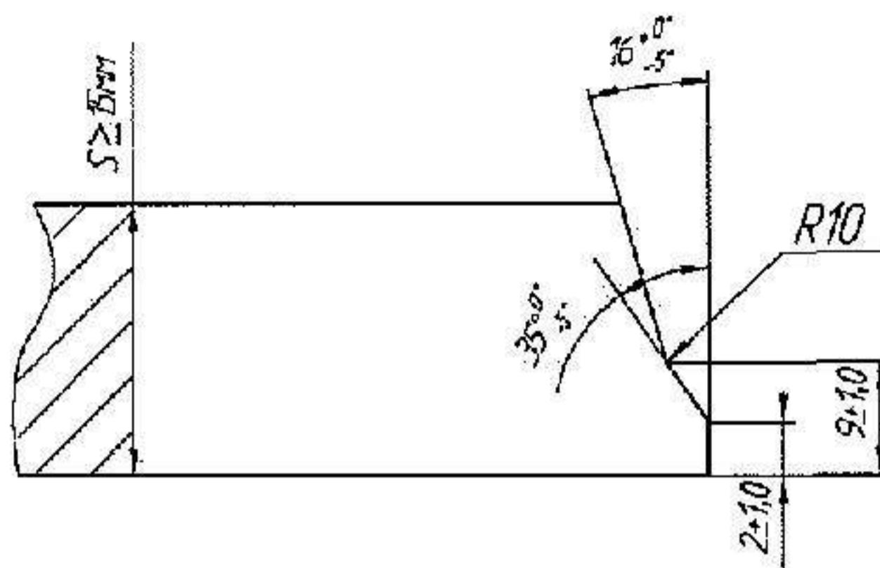
**П р и м е ч а н и е –** Радиус сопряжения R10 обеспечивается технологией производства и указан для справок.
